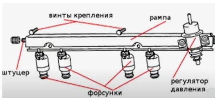
Рисунок 4 – Топливная рампа
