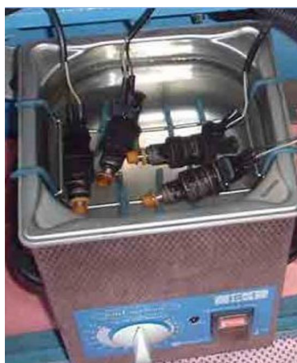
Рисунок 3 – Ультразвуковая очистка форсунок
