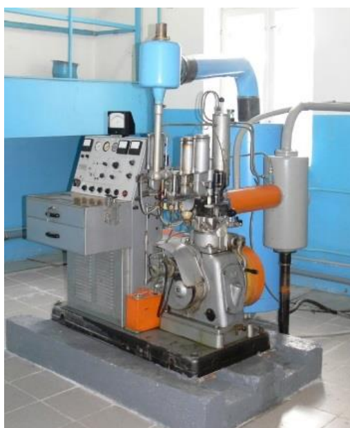
Рисунок 23 – Установка УИТ-85 для проведения экспериментальных работ
