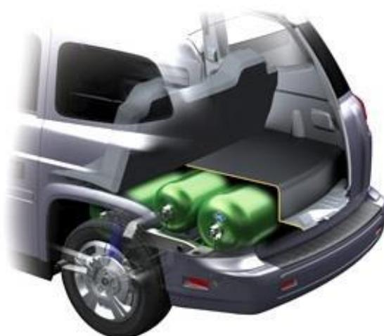
Рисунок 10 – Топливный бак автомобиля, использующего природный газ в качестве топлива [48]
