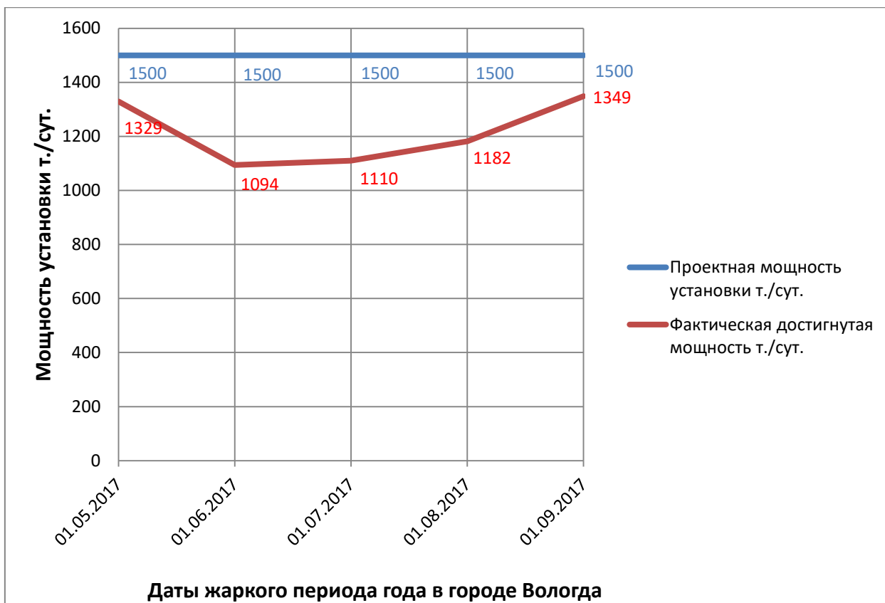
Рисунок 3 – Диаграмма данных работы установки до монтажа абсорбционной бромистолитиевой холодильной машины (АБХМ) на предприятии АО «Апатит»
