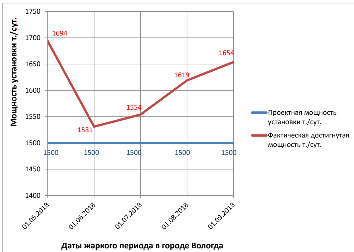
Рисунок 5 – Диаграмма данных работы установки с использованием абсорбционной бромистолитиевой холодильной машины (АБХМ) на предприятии АО «Апатит»
