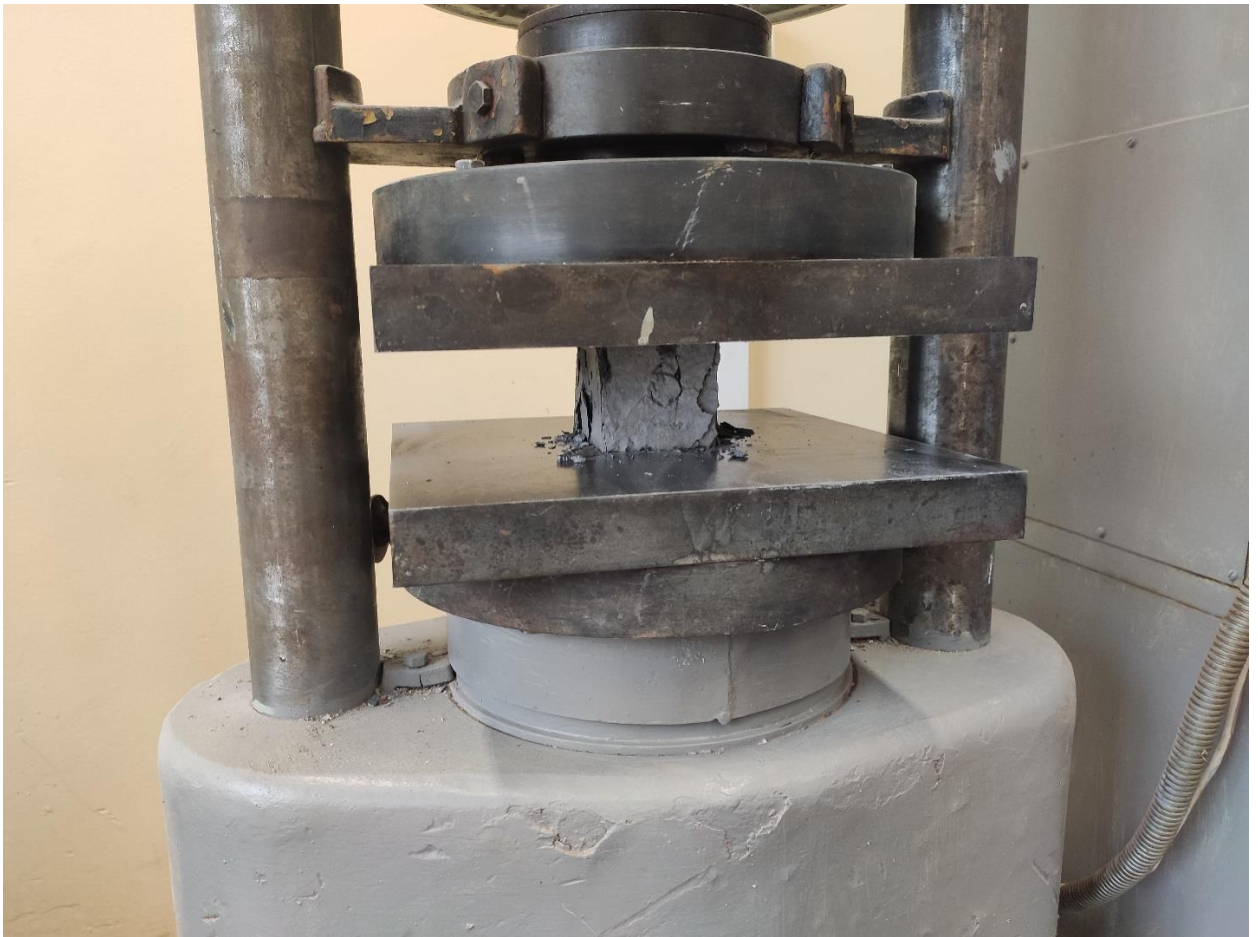
Рисунок 32 – Разрушенный бетонный образец под действием сжимающей силы, гидравлического пресса марки «ПГ-50»
