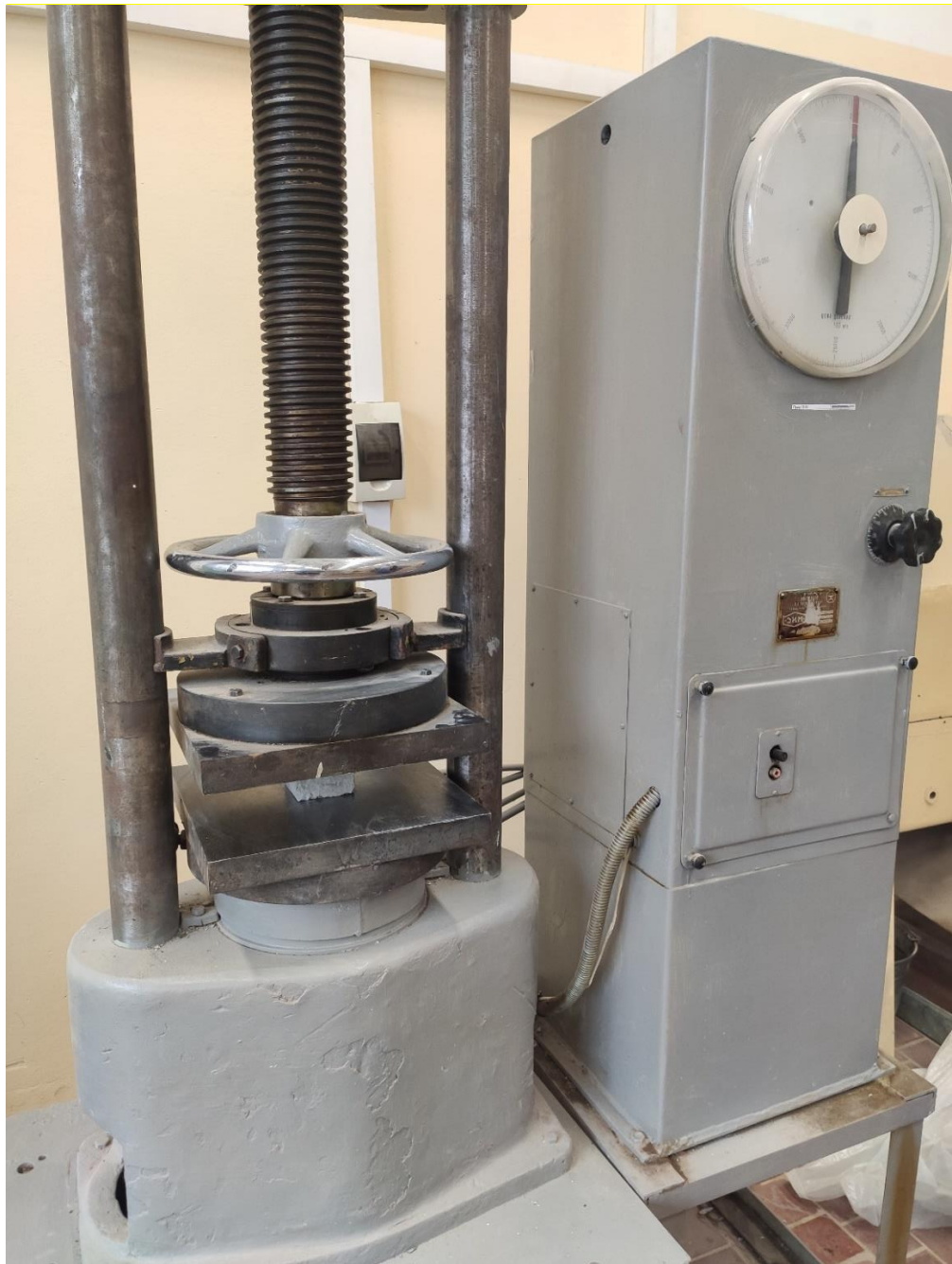
Рисунок 31 – Общий вид гидравлического пресса марки «ПГ-50» с подготовленным бетонным образцом
