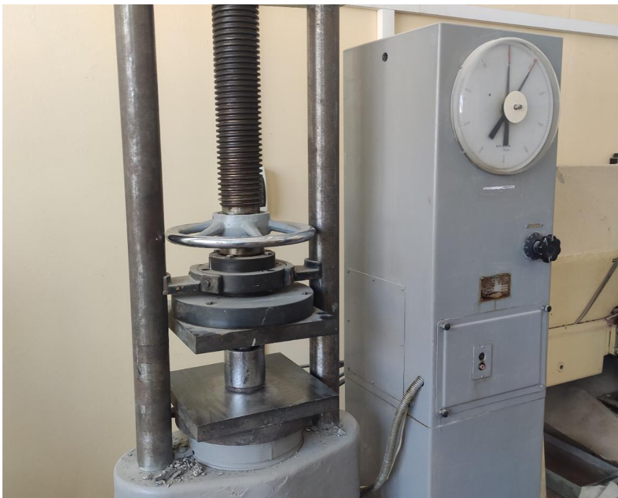
Рисунок 24 – Цилиндр, размещенный в гидравлическом прессе марки «ПГ-50»
