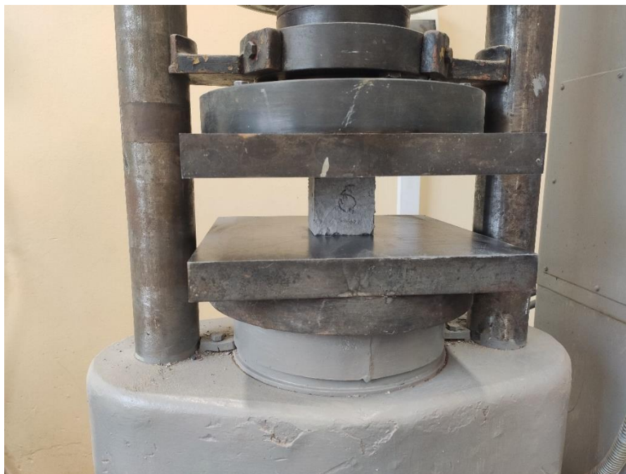
Рисунок 30 – Установленный бетонный образец на площадку гидравлического пресса марки «ПГ-50»
