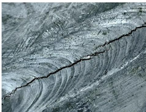
Рисунок 43 – Трещина сварного шва
