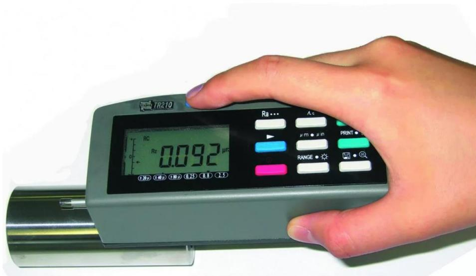
Рисунок 18 – Профилометр
