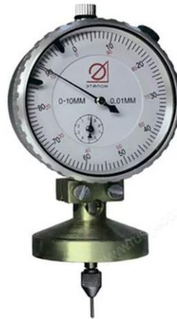
Рисунок 10 – Механический глубиномер
