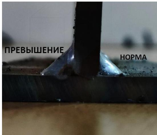
Рисунок 60 – Превышение углового шва
