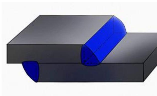
Рисунок 29 – Нахлесточное соединение
