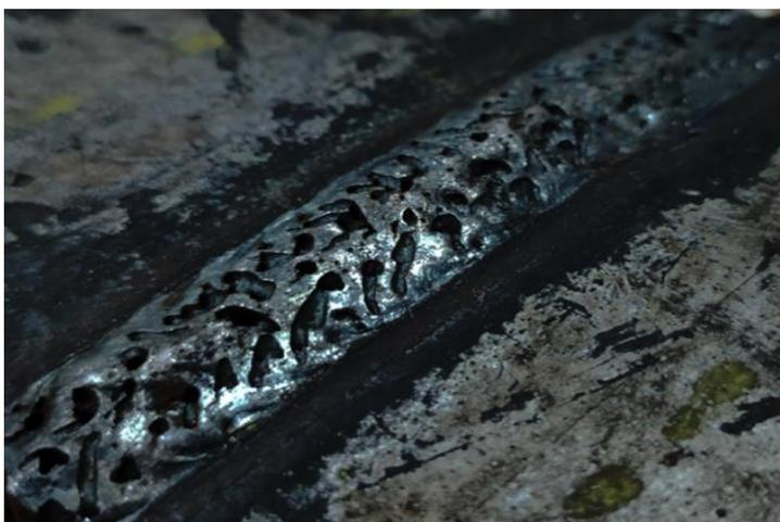
Рисунок 45 – Поверхностная пора
