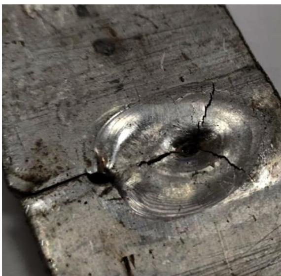
Рисунок 44 – Кратерная трещина
