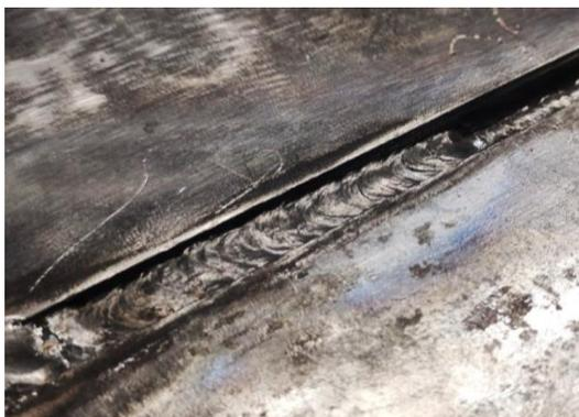
Рисунок 55 – Незаполненная разделка кромок
