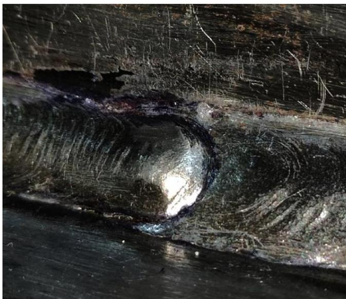
Рисунок 58 – Плохое повторное возбуждение дуги
