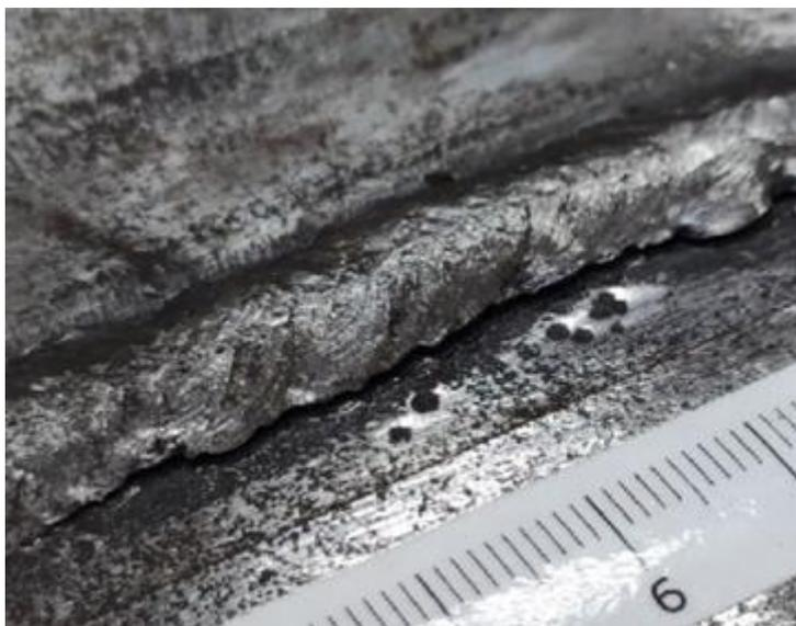
Рисунок 47 – Несплавление сварного шва
