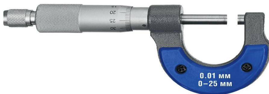
Рисунок 9 – Микрометр
