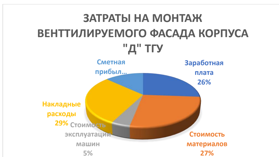
Рисунок Д.1 - Диаграмма затрат на монтаж вентилируемого фасада
