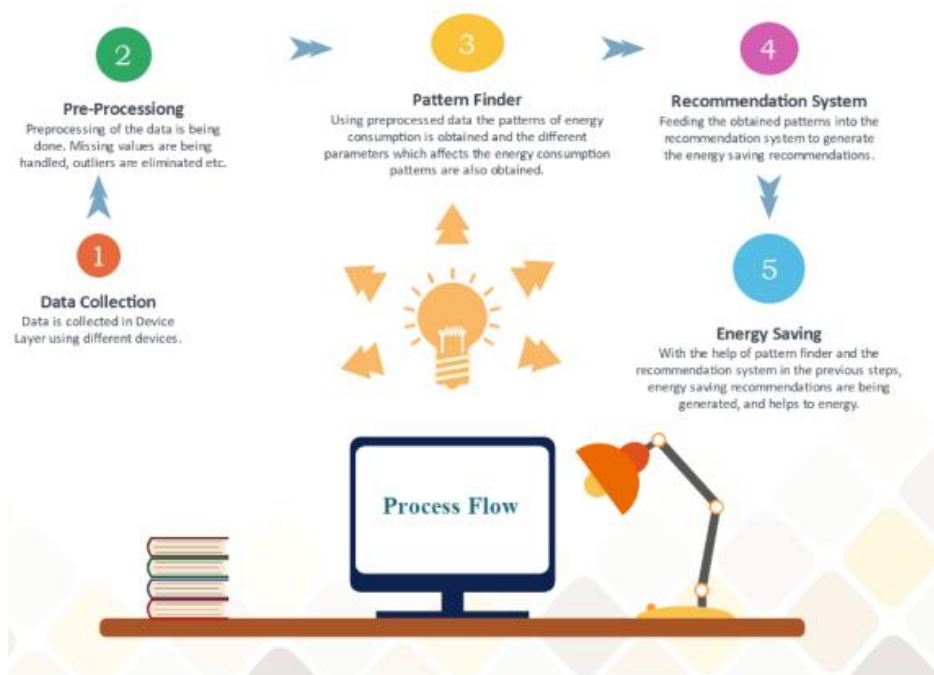
Рисунок 6 – Диаграмма потоков архитектуры системы управления домашним энергопотреблением
