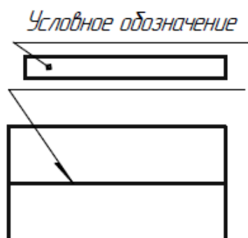
Рисунок 6.42 – Изображение видимого шва [25]
