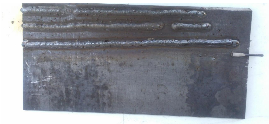
Рис. 2.4. Расплавление электродов по частям в соотношении 1/3 и 2/3 от полной длины и целого электрода.
