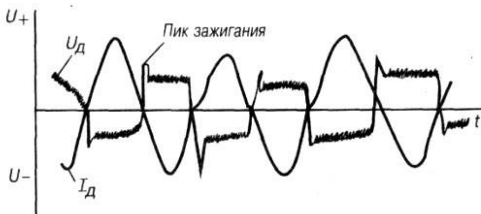
Рис. 1.5. Формы тока и напряжения дуги при горении дуги на переменном токе
