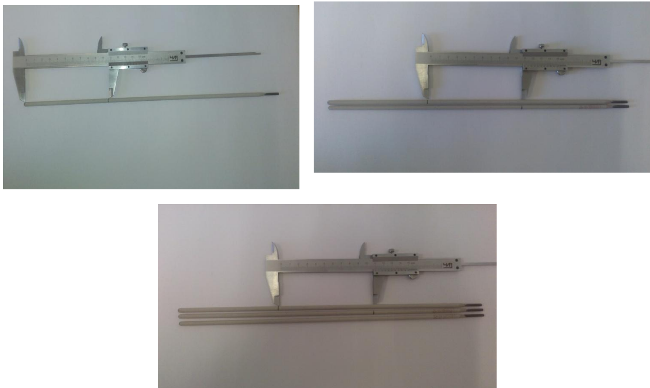
Рис. 2.3. Разметка электродов в соотношении 1/3 и 2/3 от полной длины
