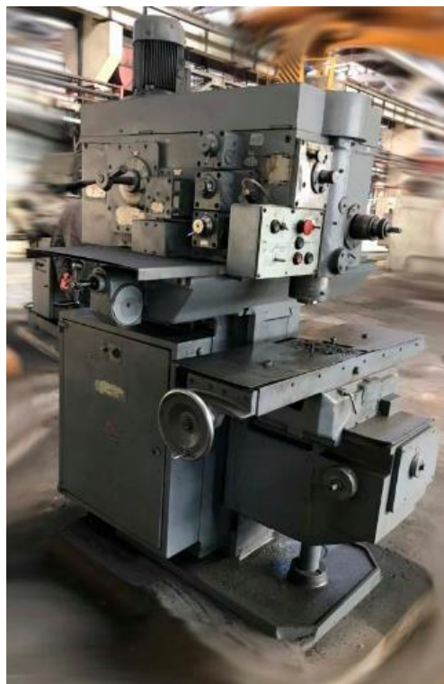
Рисунок 7 - Шпоночно-фрезерный станок модели 692Д
