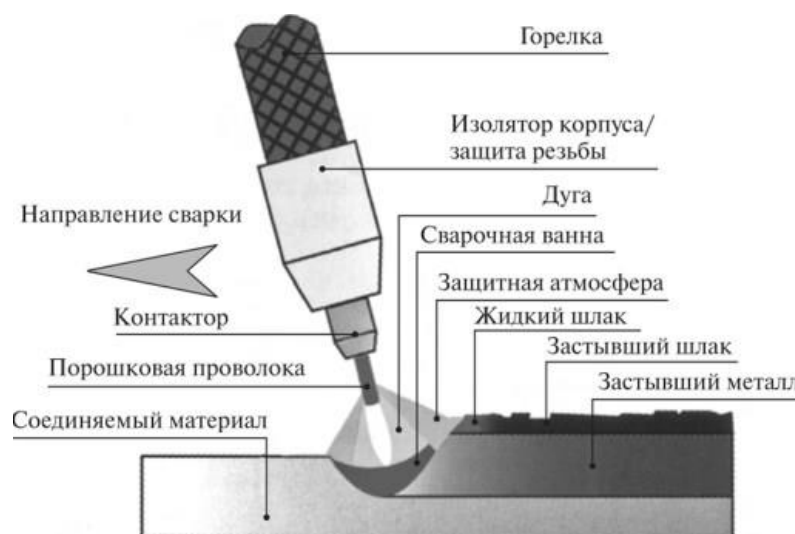
Рисунок 7 – Схема процесса сварки самозащитной порошковой проволокой
