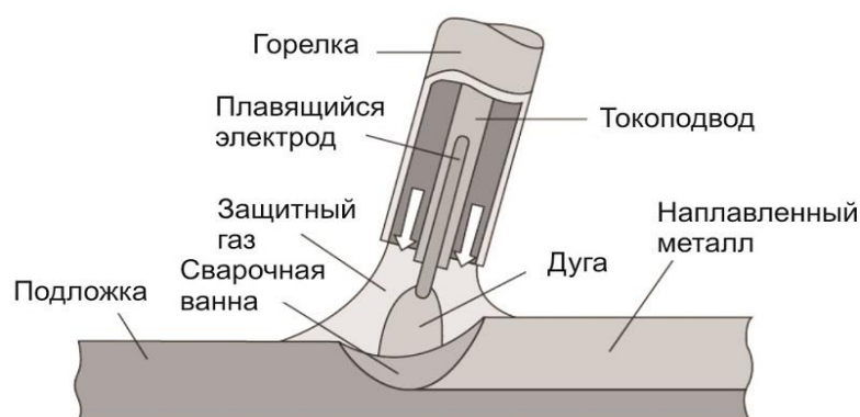
Рисунок 6 – Схема процесса механизированной сварки плавящимся электродом в среде защитных газов или смесей
