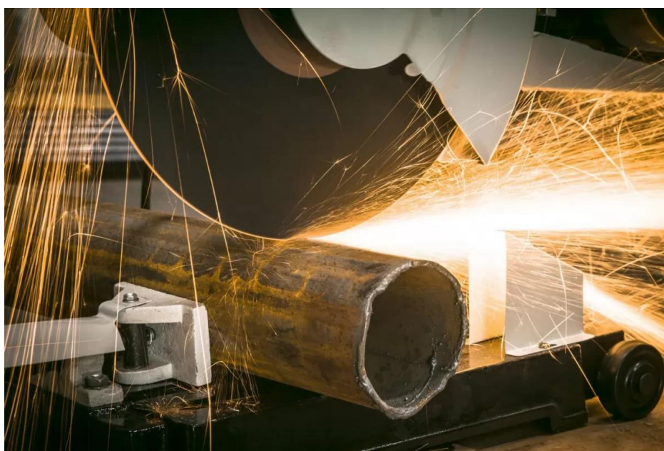
Рисунок 13 – Резка трубы для напольной вешалки для малых помещений
