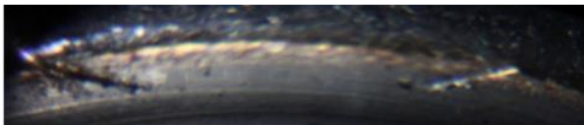
Рисунок 3 – Статический след звездчатого экстрактора пистолета «Оса ПБ4-1» на передней части фланца гильзы травматического патрона 18×45Т
