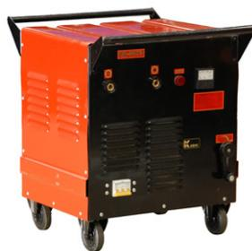
Рисунок 3 – Сварочный выпрямитель ВД-301
