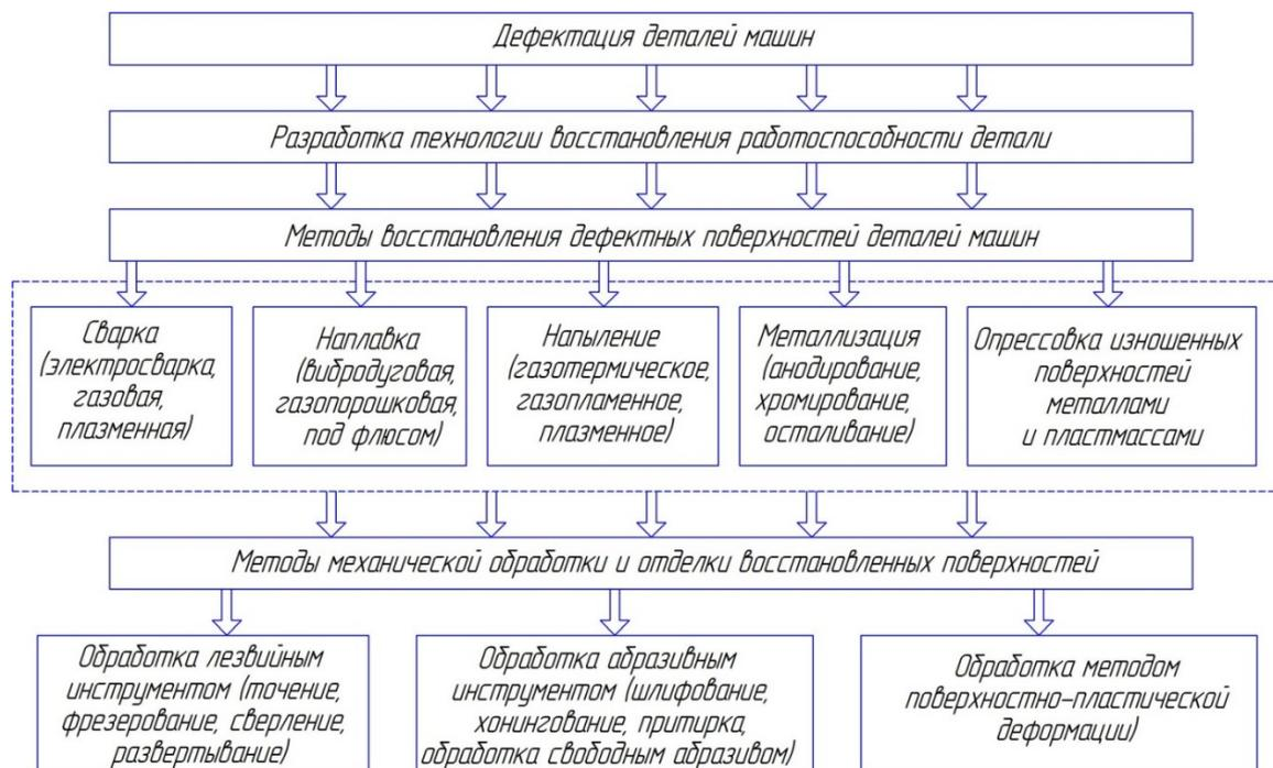
Рисунок 13 – Схема выбора способа восстановительной наплавки
