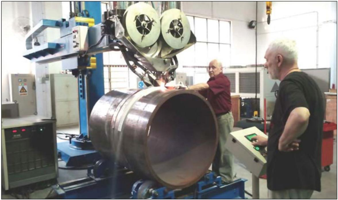
Рисунок 20 – Установка для электрошлаковой наплавки лентами деталей диаметром 1000 мм
