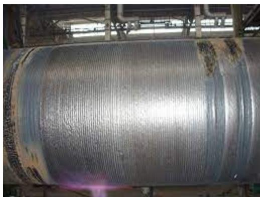
Рисунок 7 – Поверхность наплавленного вала
