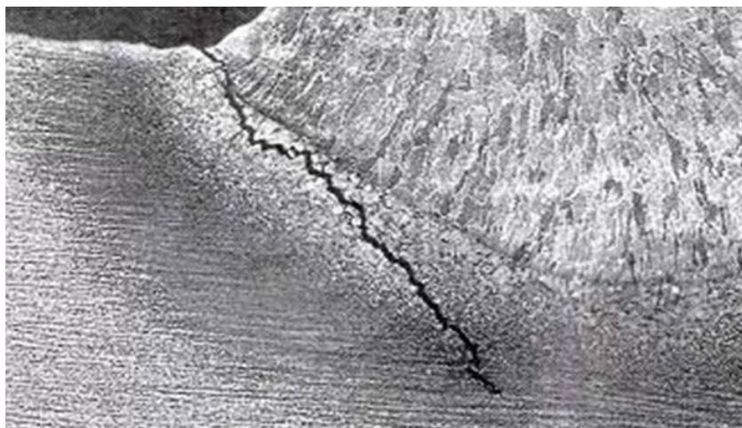
Рисунок 3 – Горячие трещины при сварке стали 12Х18Н10Т» [25]
