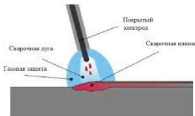
Рисунок 14 – Схема ручной дуговой наплавки
