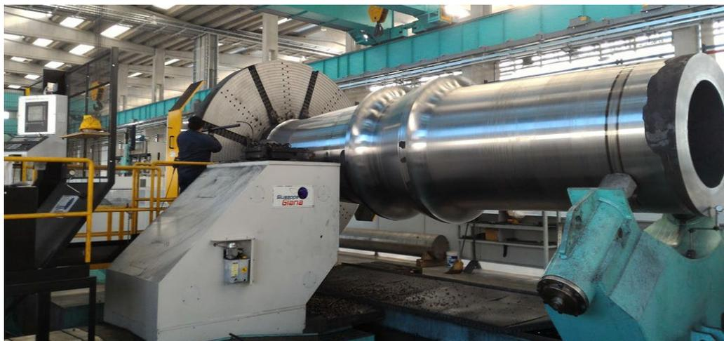
Рисунок 5 – Обточка валов на токарном станке GG-TRONIC
