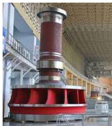
Рисунок 1 – Валы гидравлических турбин
