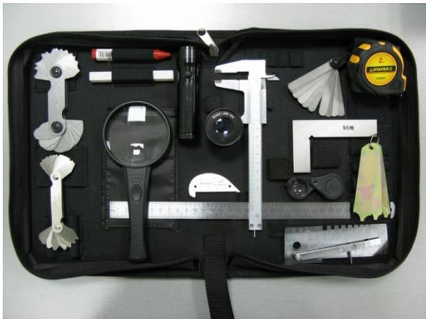
Рисунок 8 – Комплект для визуального и измерительного контроля
