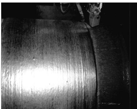
Рисунок 24 – Внешний вид вала после наплавки
