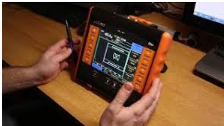
Рисунок 9 – Дефектоскоп UCD-50 для ультразвукового контроля
