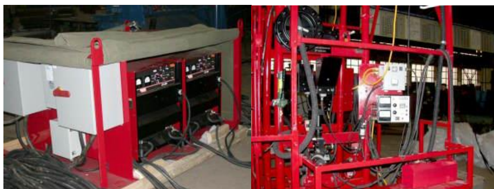
Рисунок 7 – Сварочный выпрямитель DC-600 (а) и сварочная головка NA-3 (б) производства Lincoln Electric
