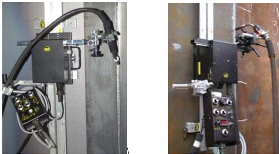
Рисунок 9 – Портативная каретка Universal для сварки вертикальных стыков резервуаров
