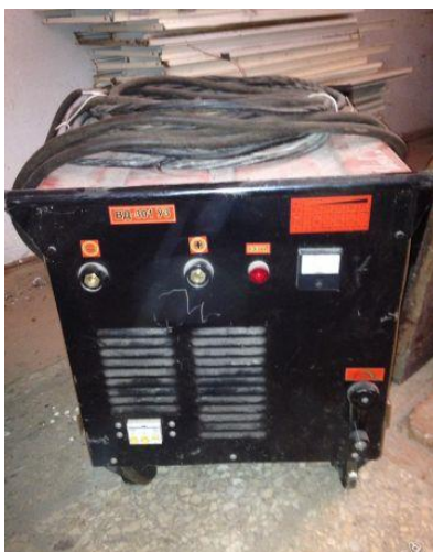
Рисунок 3 – Оборудование для восстановительной наплавки вала: сварочный выпрямитель ВД-301
