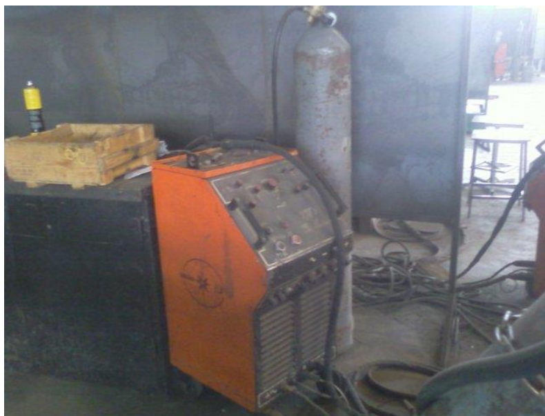
Рисунок 5 – Пост для исправления дефектов алюминиевого литья с применением аргонодуговой сварки неплавящимся электродом
