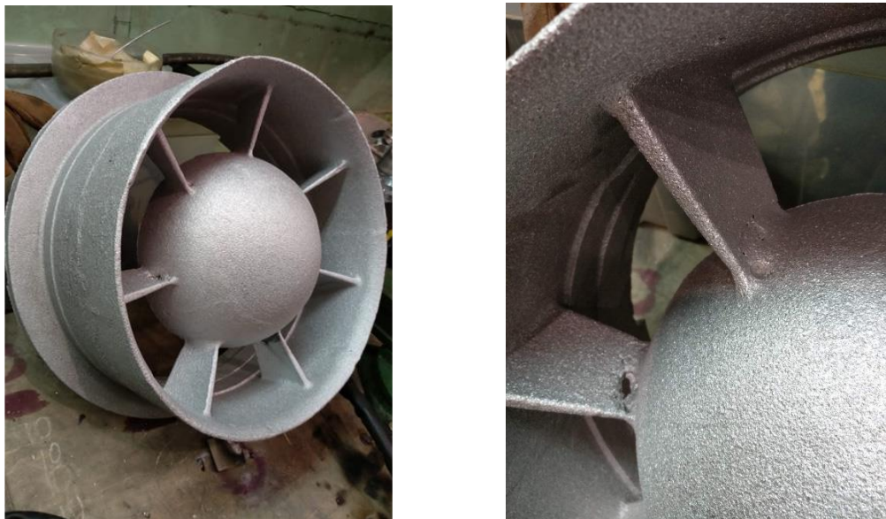
Рисунок 4 – Отливка направляющего аппарата (а) и дефекты литья (б)
