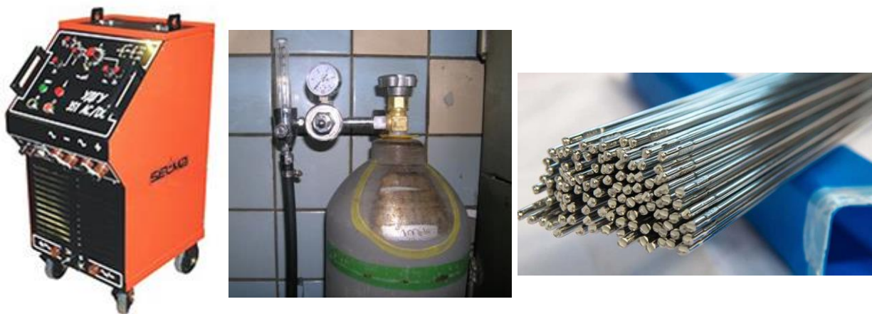
Рисунок 6. Источник питания УДГУ-351 (а), баллон с аргонem (б), присадочный пруток СвАК5 (в)
