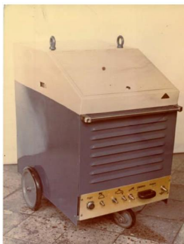
Рисунок 15 – Установка для сварки свободной трехфазной дугой УДГТ-314
