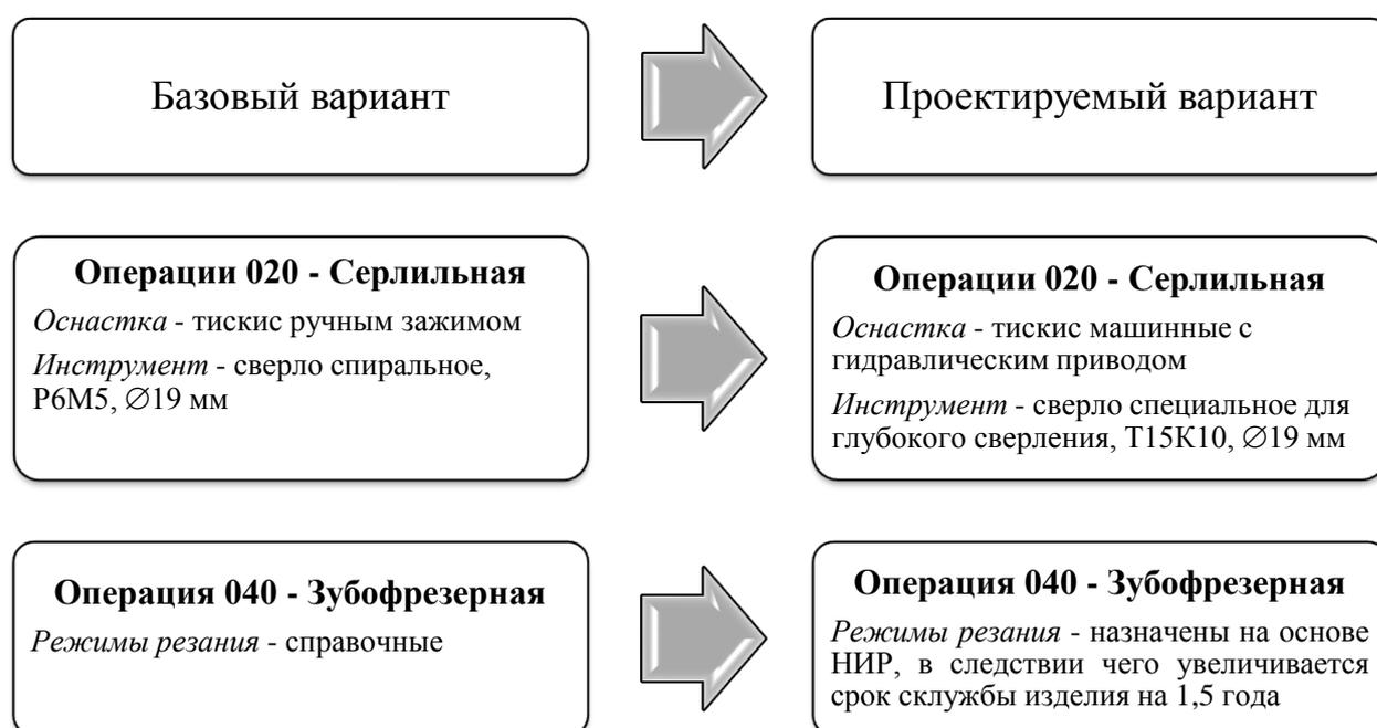
Рисунок 3 – Краткое описание, внесенных в технологический процесс, изменений
