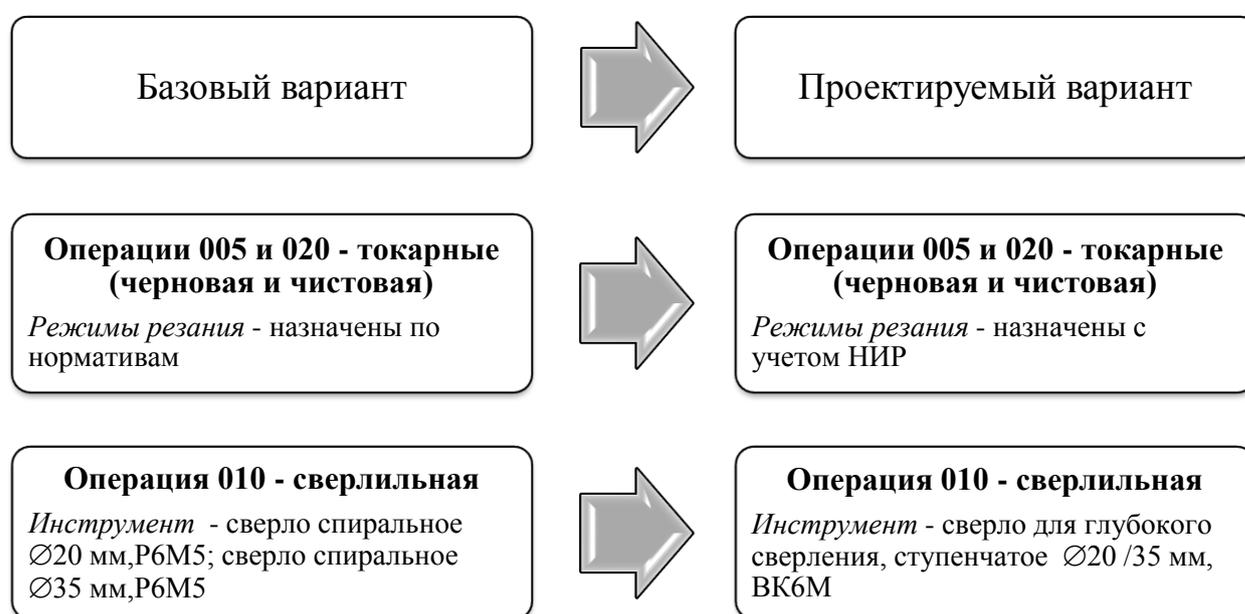
Рисунок 3 – Краткое описание, внесенных в технологический процесс, изменений
