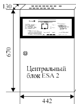
Рисунок 2– Щит пожарной сигнализации для двух шлейфов
