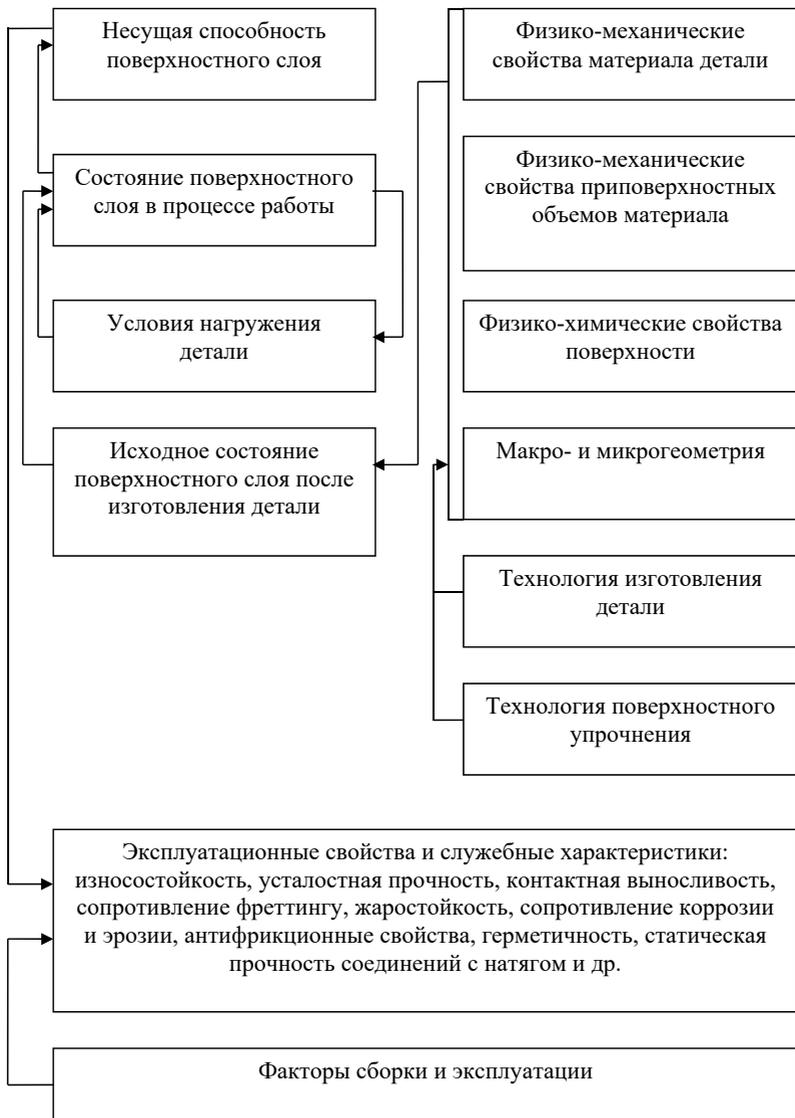
Рис. 4. Схема обеспечения эксплуатационных свойств путем управления несущей способностью поверхностного слоя
