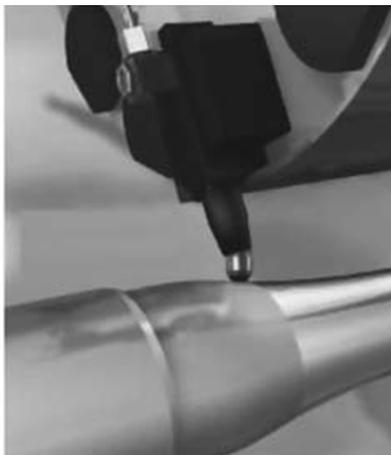
Рис. 121. Фото процесса упрочняюще-сглаживающего обкатывания цилиндрической поверхности шаром и роликами
