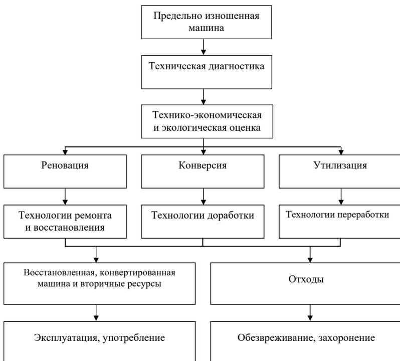
Рис. 2. Структурная схема рециклинга машин
