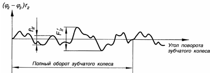
Рис. 44. График, характеризующий точность контролируемого колеса
