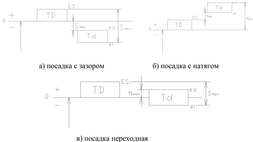
Рис. 2. Взаимное расположение полей допусков для различных типов посадок
