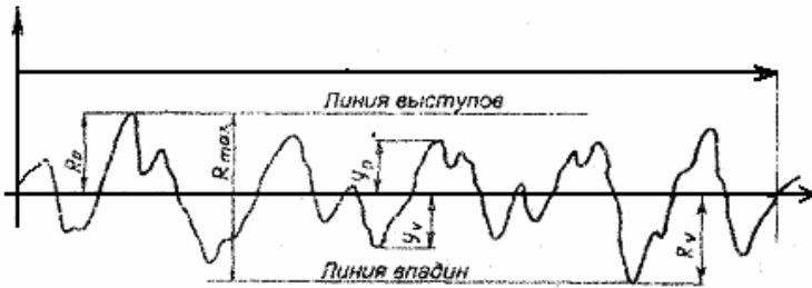
Рис. 9. Параметры шероховатости, связанные с высотными свойствами неровностей
