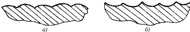
Рис. 15. Профили неровностей поверхностей: а — выпуклость; б — вогнутость
