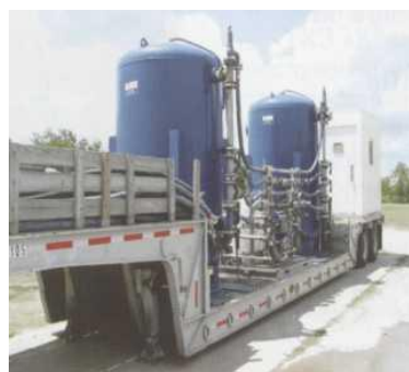
Рисунок 3 – Внешний вид установок, производства компании MPR Services для комплексной очистки аминов: а — стационарная; б — мобильная на автоприцепе
