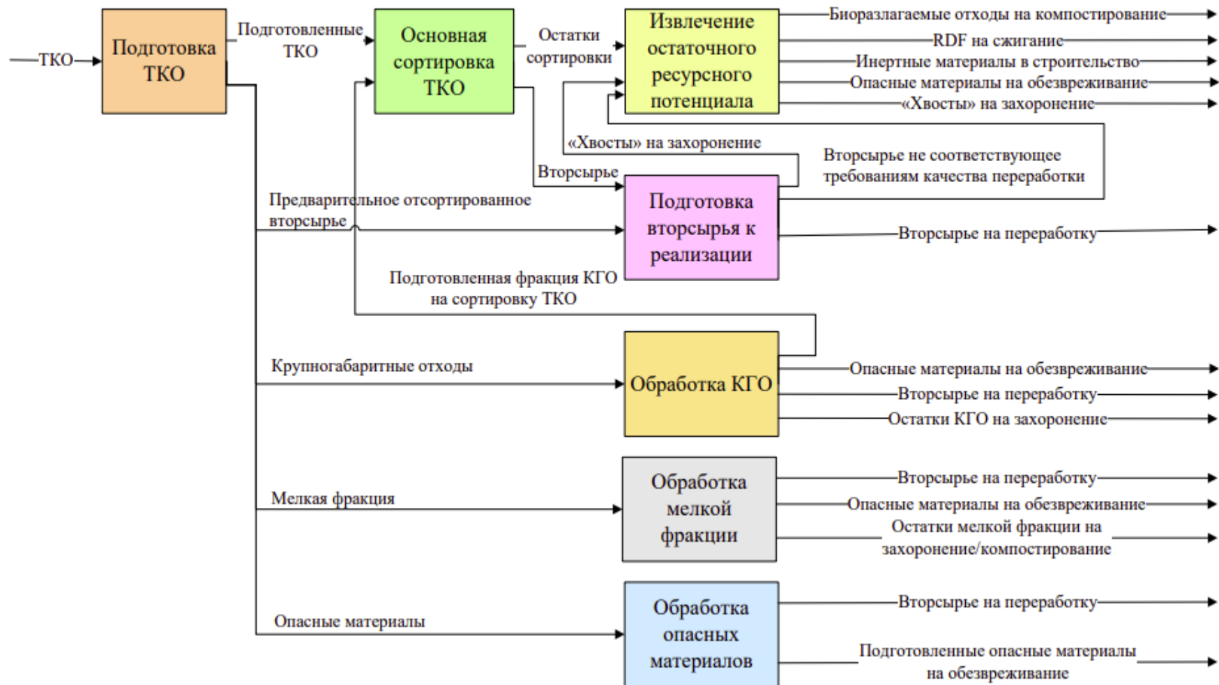
Рисунок 3 – Сортировка отходов. Схема технологическая
