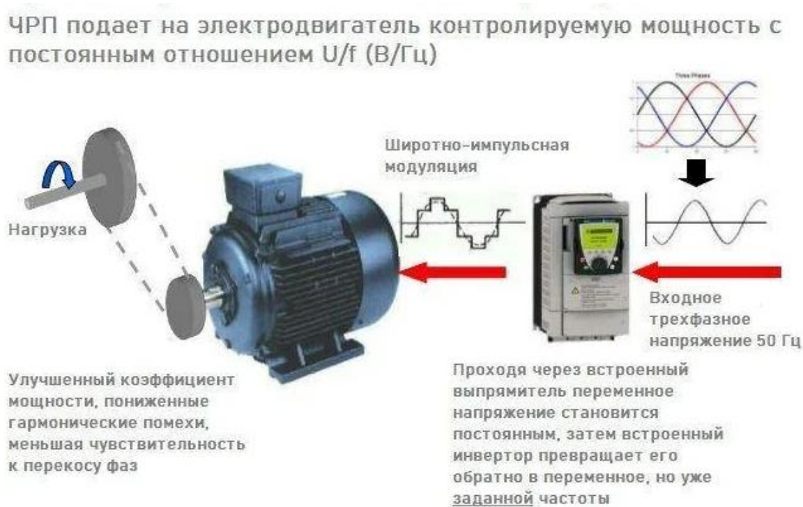
Рисунок 3 – Принцип работы частотного преобразователя
