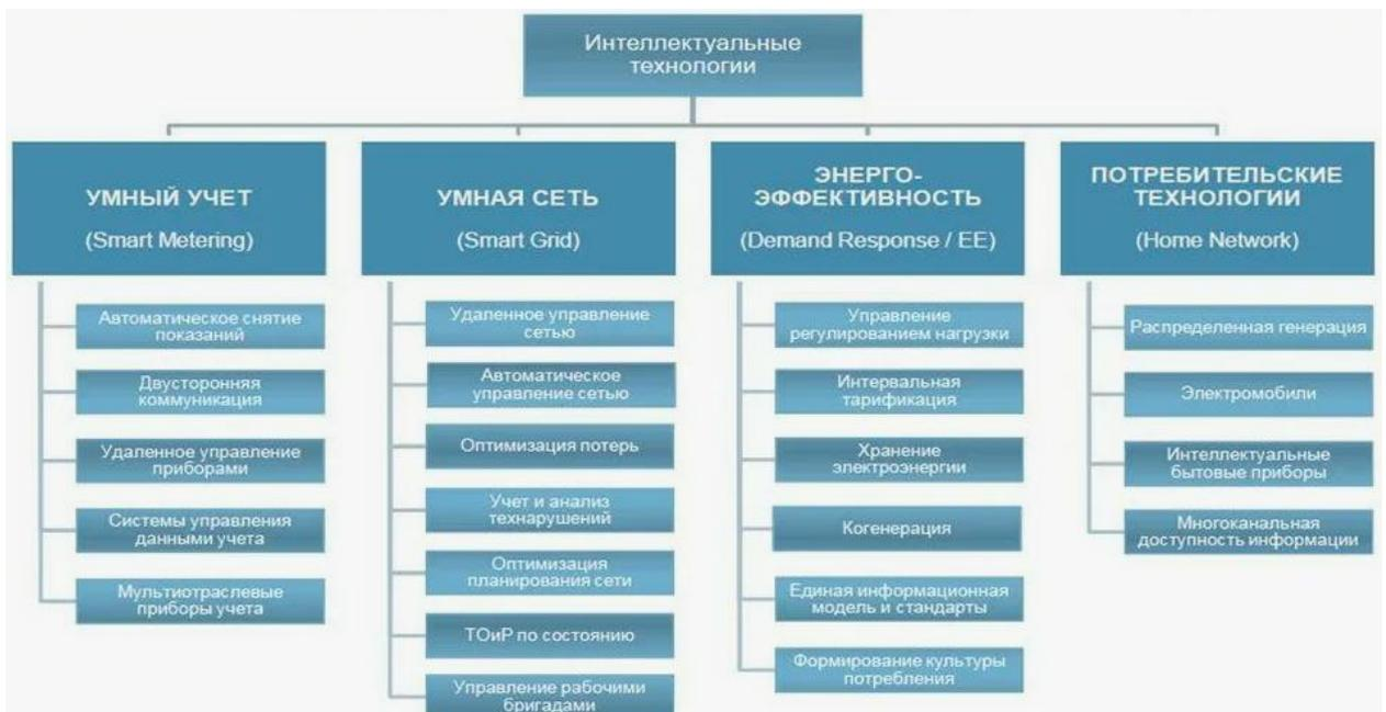
Рисунок 3 – Структура технологического базиса Smart Grid
