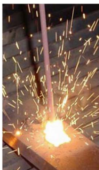
Рис. 8. Дуговая сварка: a – процесс электродуговой сварки; б – электроды
