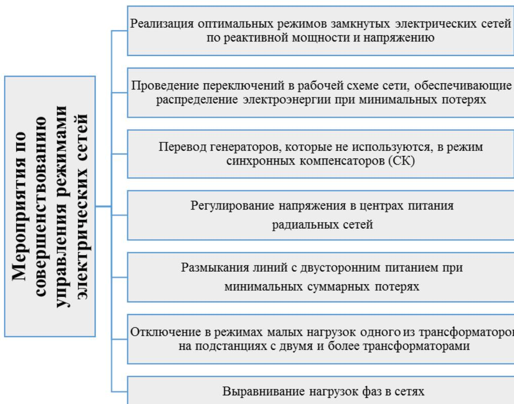
Рисунок 5 – «Мероприятия по усовершенствованию управления режимами сетей» [9]
