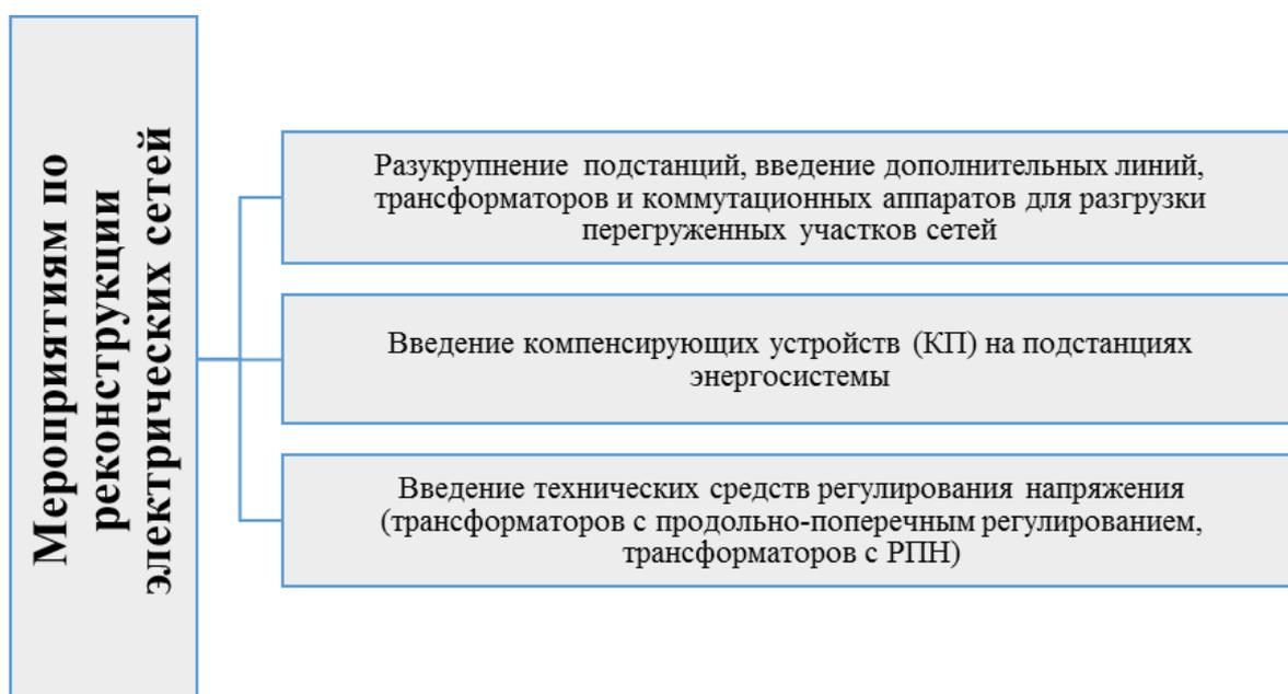
Рисунок 7 – «Мероприятиям по реконструкции электрических сетей» [9]
