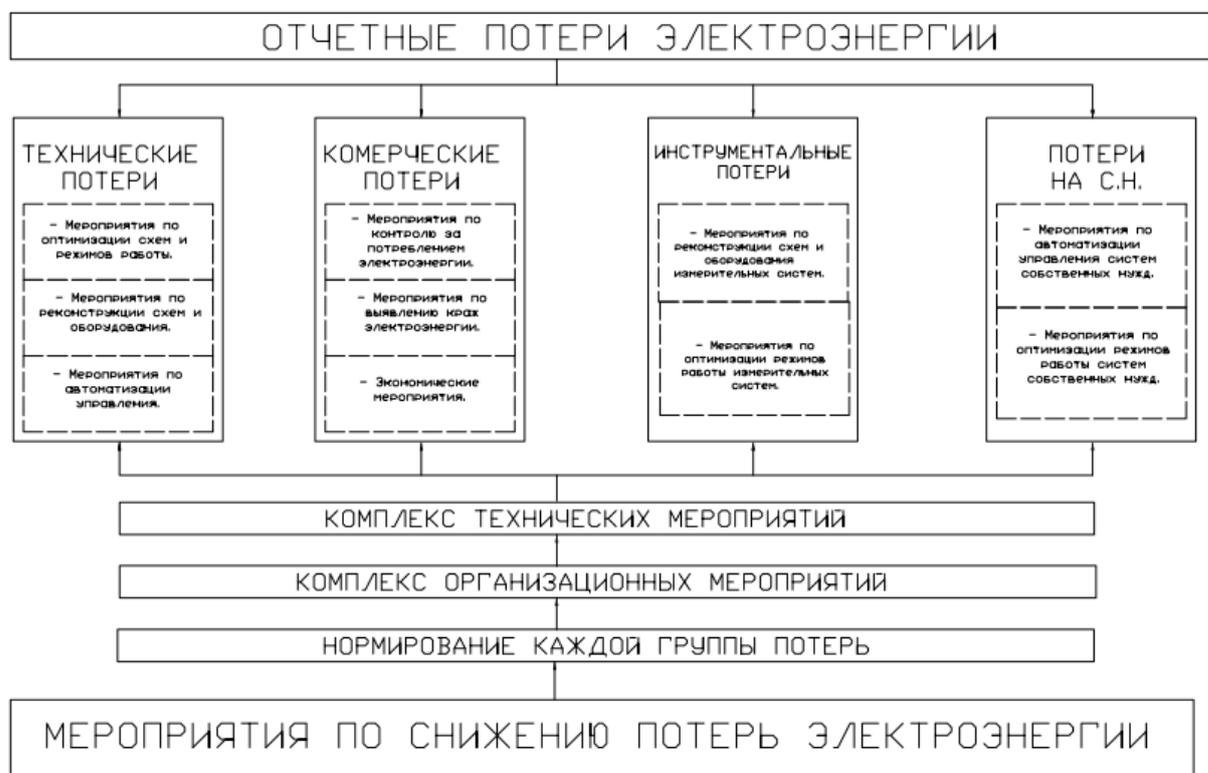
Рисунок 11 – Комплекс мероприятия по минимизации потерь электроэнергии в системе электроснабжения проектируемого жилого многоэтажного дома
