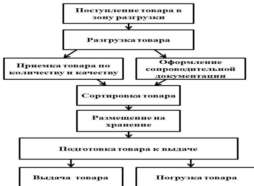
Рисунок 3 – Схема технологического процесса на складах ТЦ «Корона-Уручье»
