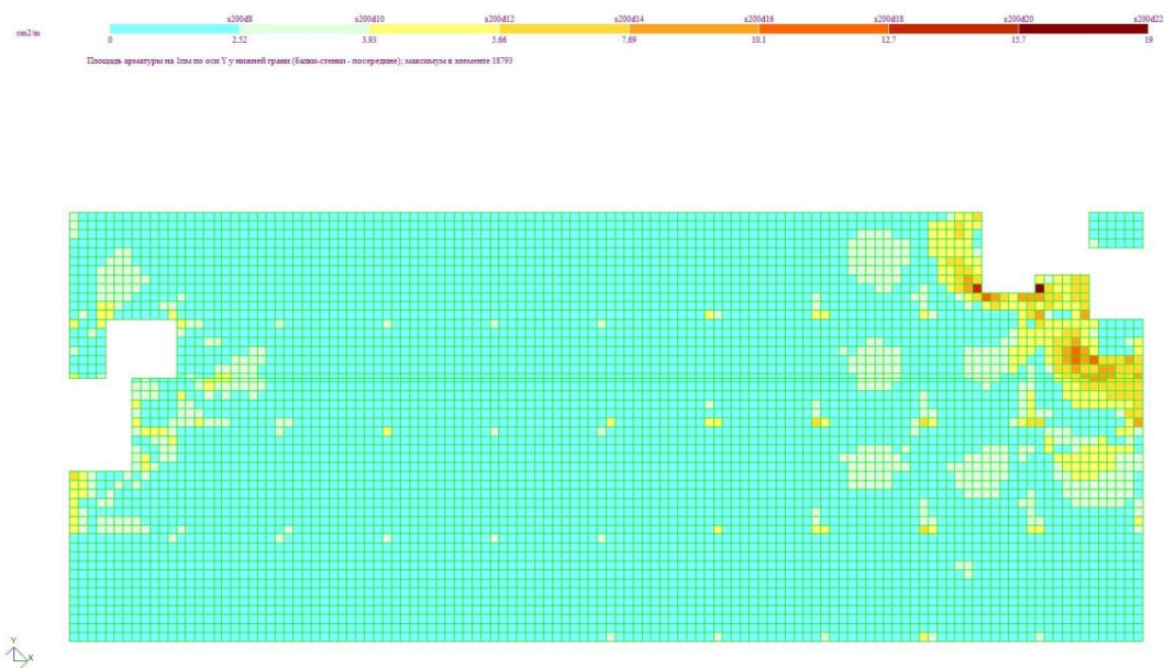
Рисунок 11 - Площадь арматуры по цифровым осям нижней зоны
