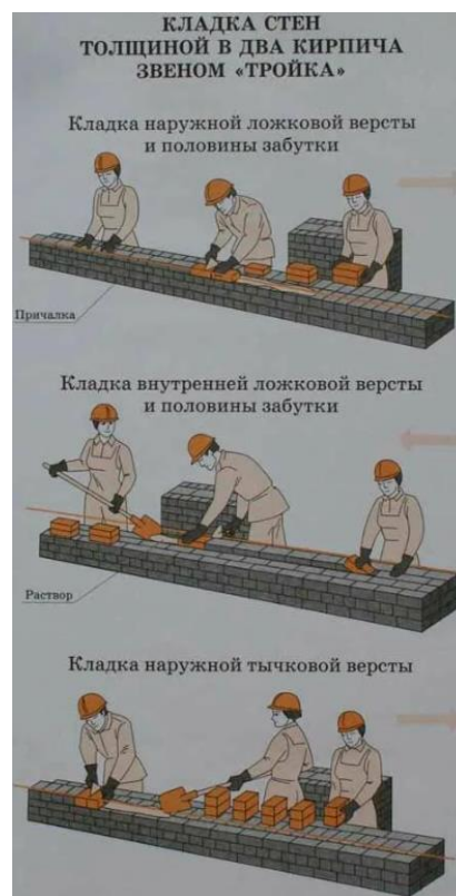
Рисунок 9 – Схема рабочего места каменщиков.
