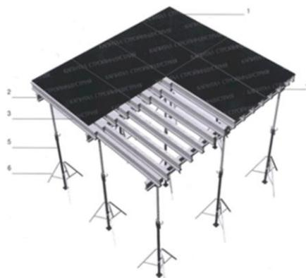
«1 – палуба (фанера толщиной 18-20мм); 2 – главная балка (продольная); 3 – второстепенная балка (поперечная); 4 – вилка универсальная; 5 – стойка опорная телескопическая; 6 – тренога»
