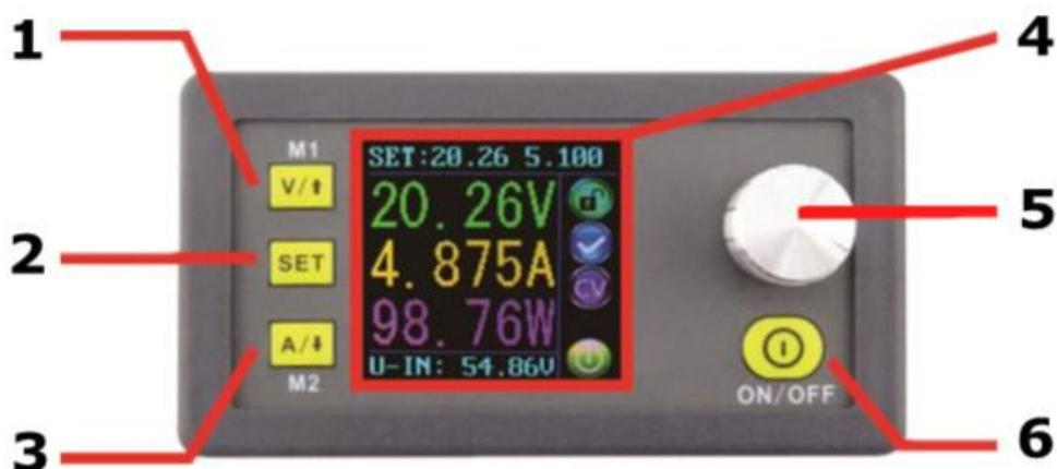
Рисунок 5 – Органы управления устройства DPS5005-C
