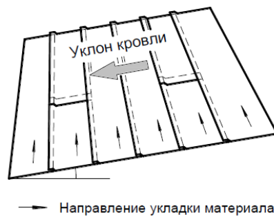
Рисунок 6 – Укладка материала на скате крыши параллельно уклону
