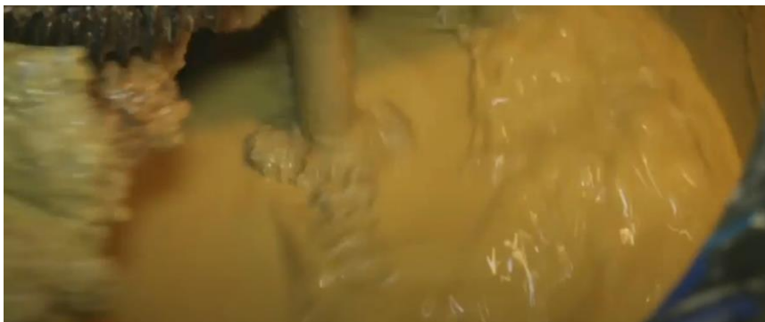
Рисунок 8 - Степень перемешивания до однородной массы подаваемых компонентов
