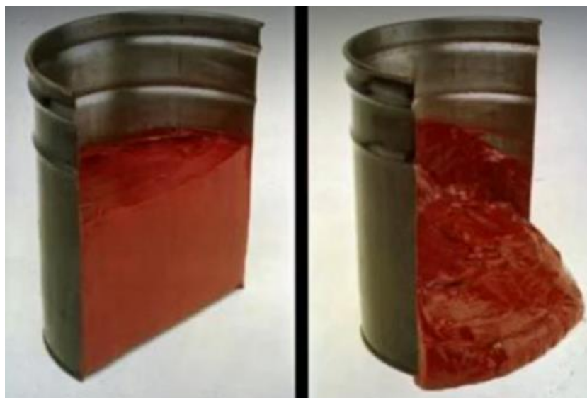
Рисунок 9 – Неравномерное распределение загустителя из-за неправильного подобранного перемешивающего устройства
