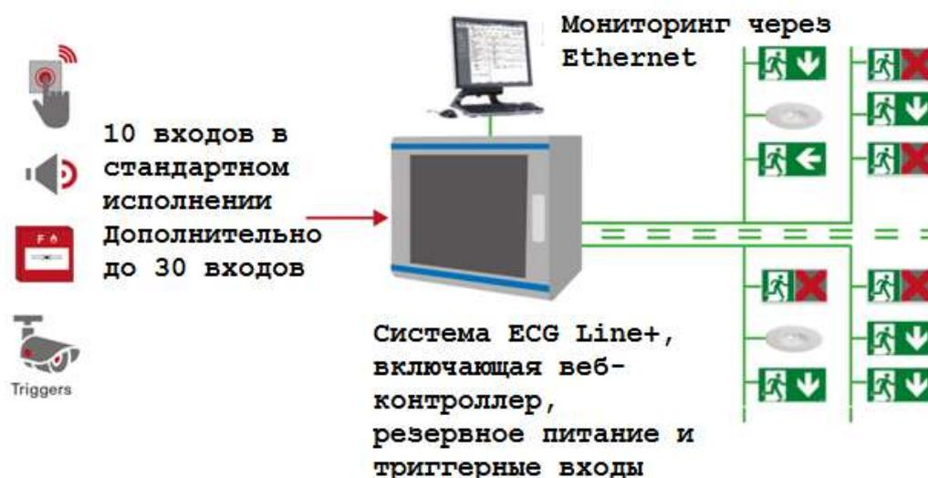
Рисунок 10 – Система Eaton AE
