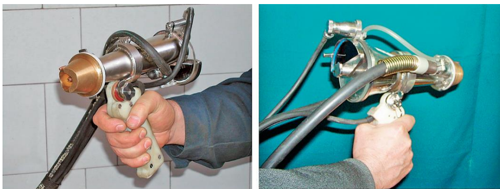
Рисунок 7 – Внешний вид сварочной горелки для проведения гипербарической сварки
