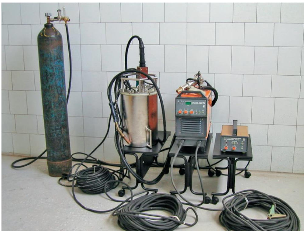
Рисунок 6 – Комплектация полуавтомата для проведения подводной сварки
