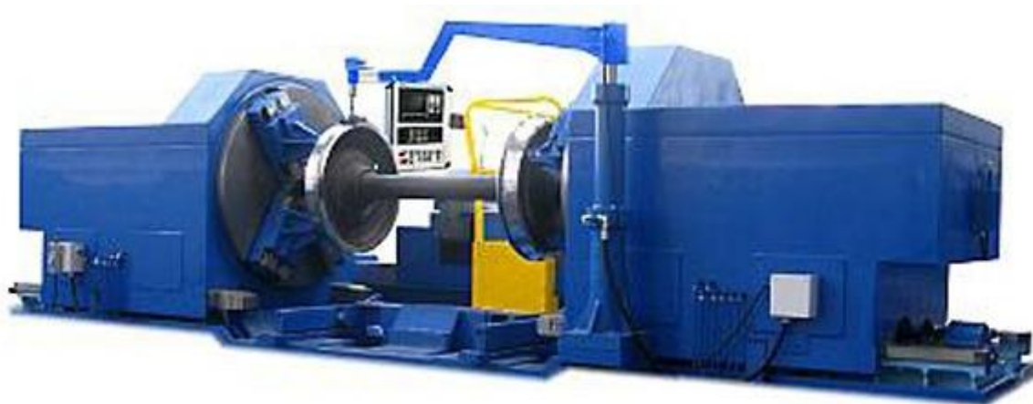
Рисунок 12 – Токарный станок для обточки колесных пар
