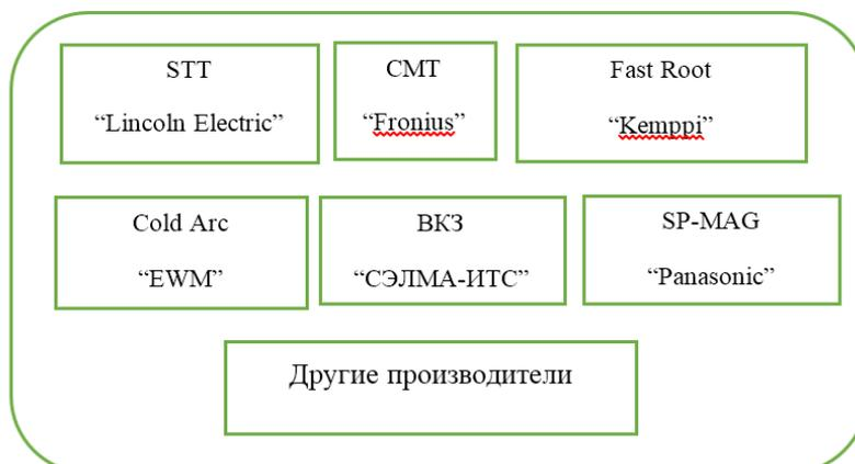
Рисунок 17 – Предлагаемые современным производителем алгоритмы управления переносом электродного металла при сварке в защитных газах
