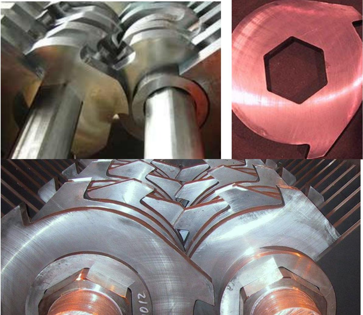
Рисунок 3 – Установка ножей на шестигранный вал шредера
