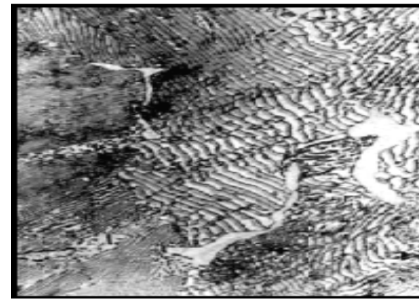
Грубопластинчатый перлит Заэвтектоидная сталь
