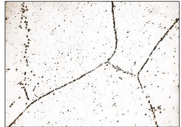
Цепочки ямок травления на малоугловых границах
