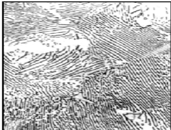
Грубопластинчатый перлит Заэвтектоидная сталь с 0,90 % С
