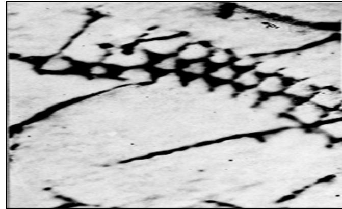
Дислокационная сетка в металле
