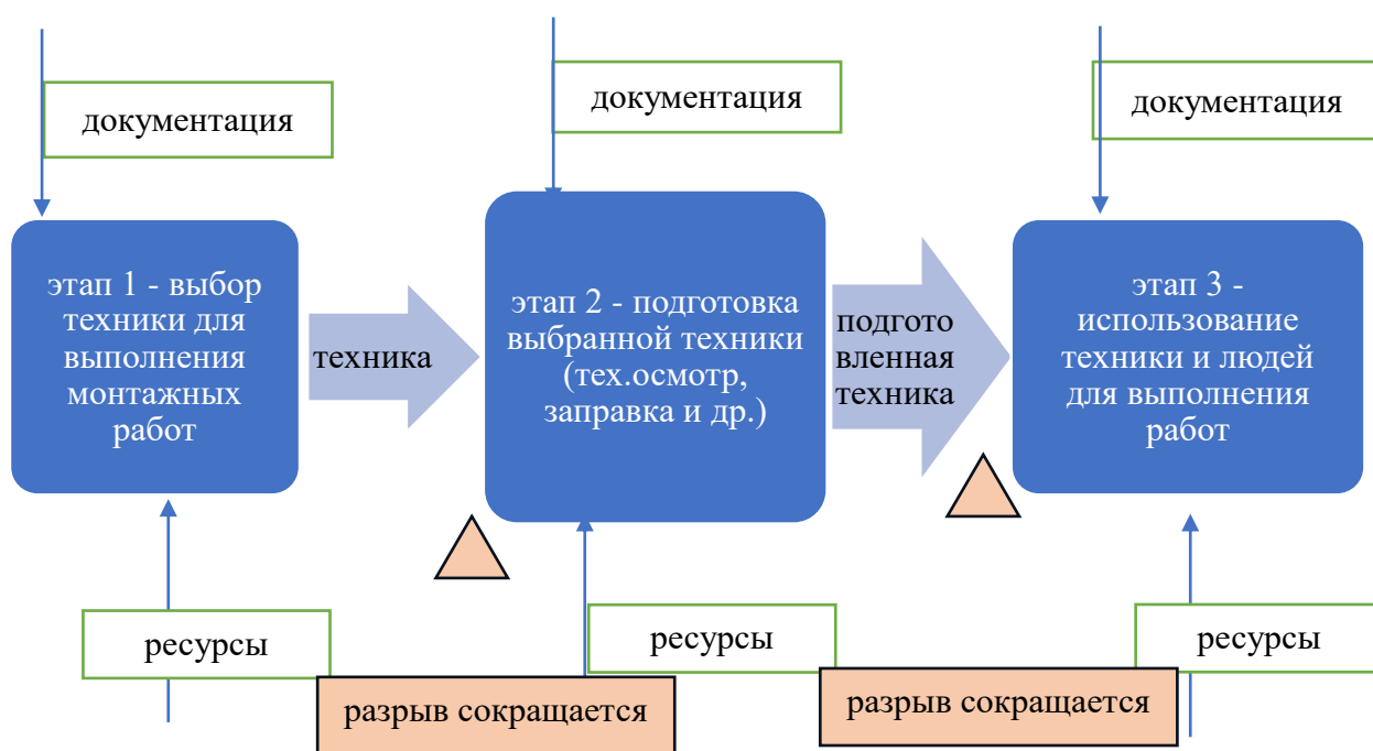
Рисунок 22 – Улучшенная схема процесса выполнения монтажных, кровельных и других высотных работ
