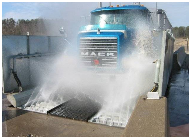
Рис. 2.25. Мойка автомобиля снизу при выезде с загрязненных участков грунтовой дороги
