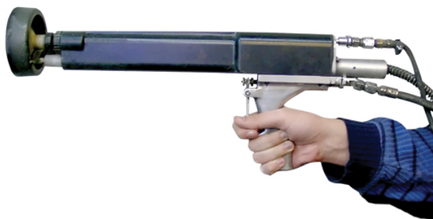
Рис. 7.58. Краскопульт установки для окраски в электростатическом поле
