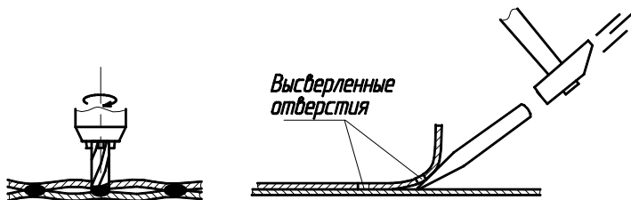
Рис. 7.27. Процедура снятия приваренной панели
