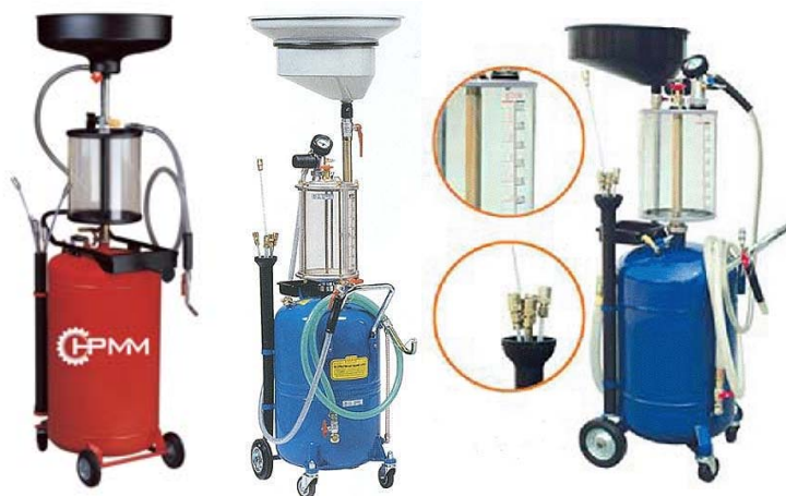
Рис. 5.21. Установки для слива масла с возможностью его отсоса из картера
