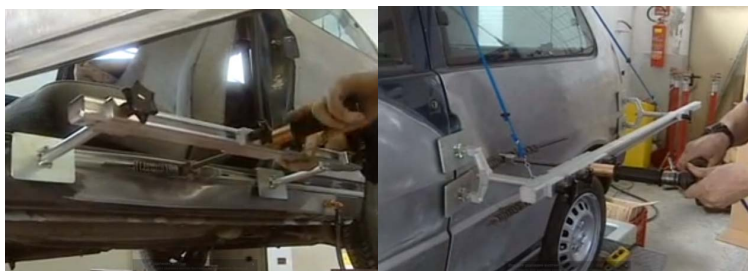
Рис. 7.49. Вид споттера при вытягивании длинной вмятины
