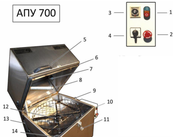
Рис. 2.34. Пример струйной мойки с вращением корзины под действием струй моющего раствора: 1 – кнопка «пуск-стоп»; 2 – кнопка аварийного выключения; 3 – таймер; 4 – сетевой выключатель; 5 – термостойкая ручка; 6 – маслобензостойкий уплотнитель; 7 – отверстие отведения пара; 8 – рампа подачи раствора; 9 – концевик, предохраняющий пуск; 10 – блок управления; 11 – замок крышки; 12 – вращающаяся корзина для промываемых деталей; 13 – опора откидной крышки; 14 – фильтр-корзина для мелких деталей
