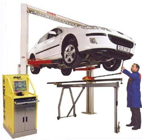
Рис. 7.6. Контроль геометрии кузова автомобиля, установленного на двухстоечный подъемник
