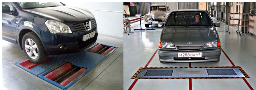
Рис. 4.35. Линия контроля ходовой части автомобиля
