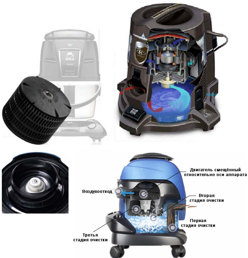
Рис. 2.41. Устройство пылесосов
