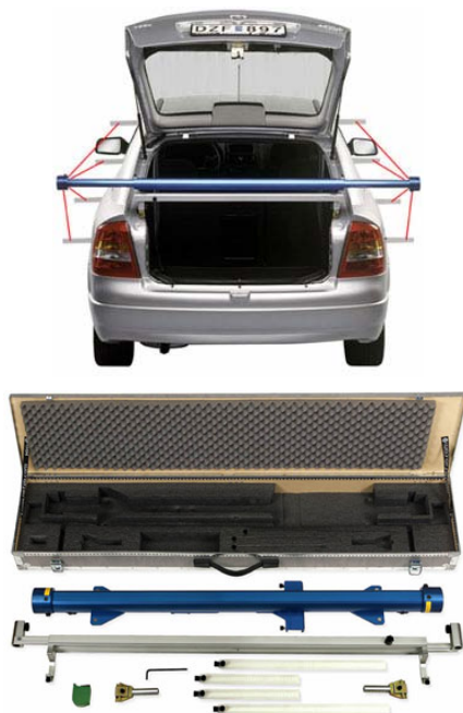
Рис. 7.5. Лазерный контроль симметричности кузова
