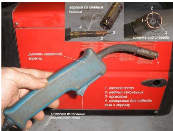
Рис. 7.36. Горелка сварочного полуавтомата
