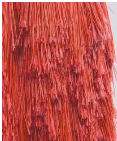
Рис. 2.30. Вид щетины щеток автомоек (щетка неподвижна)
