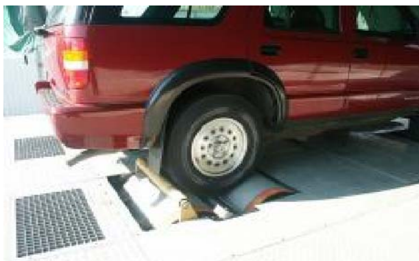
Рис. 4.10. Подъемный ролик для фиксации автомобиля от самопроизвольного съезда во время испытаний
