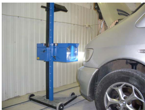
Рис. 4.56. Контроль фар на специализированном посту
