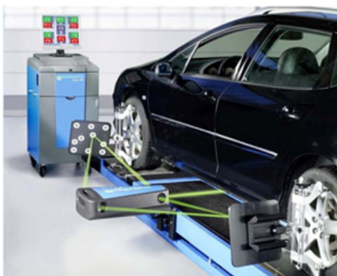
Рис. 4.44. Стенд с креплением измерительного блока к трапам подъемника
