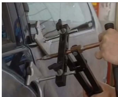
Рис. 7.47. Устройство и работа точечного споттера
