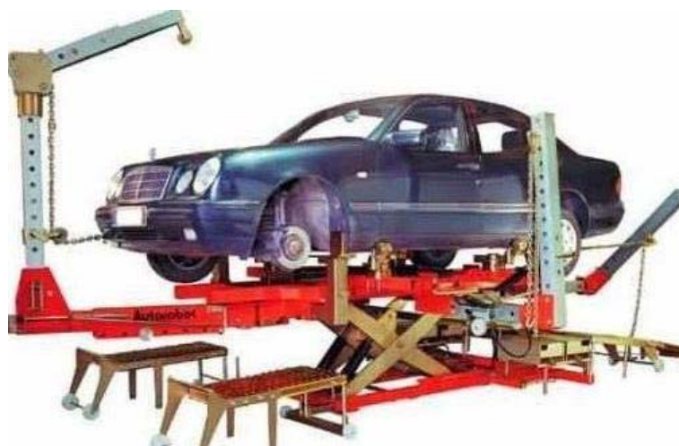
Рис. 7.21. Стапель с вертикальной силовой колонной
