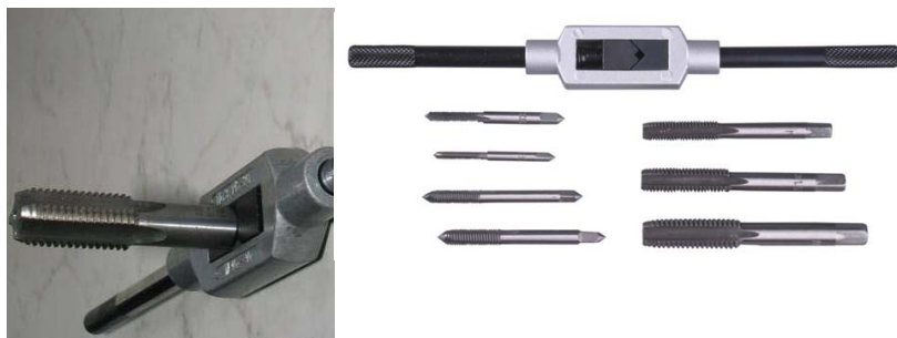
Рис. 6.93. Устройство воротка метчиков
