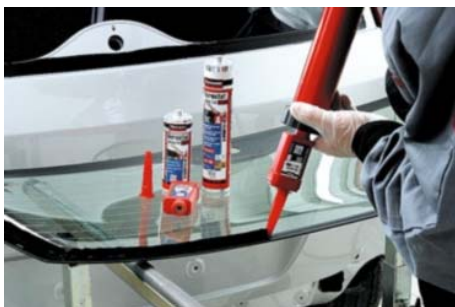
Рис. 7.67. Шприц для нанесения клея на стекло
