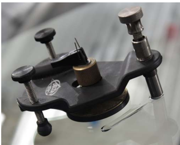
Рис. 7.69. Приспособление для вдавливания в место скола стекла смолы и отсоса воздуха
