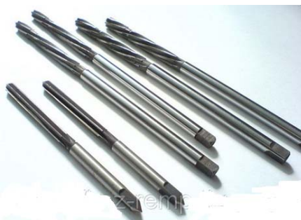
Рис. 6.88. Цельные цилиндрические развертки с прямыми и винтовыми зубьями
