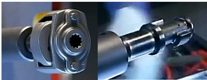
Рис. 6.34. Устройство ударного механизма гайковерта
