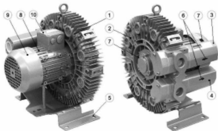
Рис. 2.6. Вихревая воздуходувка (вакуумный насос/компрессор): 1 – корпус насоса; 2 – крышка корпуса; 3 – впускное отверстие с глушителем; 4 – выпускное отверстие; 5 – основание; 6 – стрелка направления потока; 7 – стрелка направления вращения; 8 – приводной электродвигатель; 9 – кожух внешнего вентилятора; 10 – распределительная коробка
