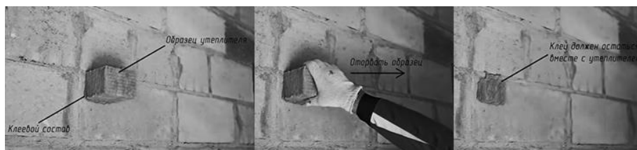
Рисунок 3.1 – Проверка адгезии клеевого состава
