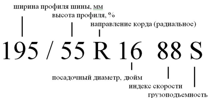
Рис. 3.1. Пример маркировки шины
