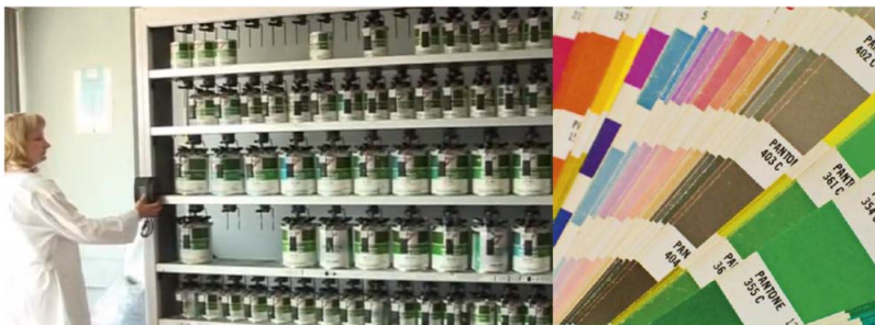
Рис. 4.1. Установка для смешивания красок и эталоны цвета
