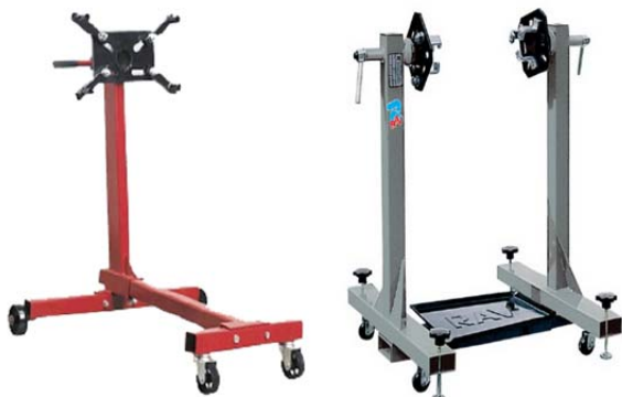
Рис. 1.1. Стенды-кантователи для разборки агрегатов
