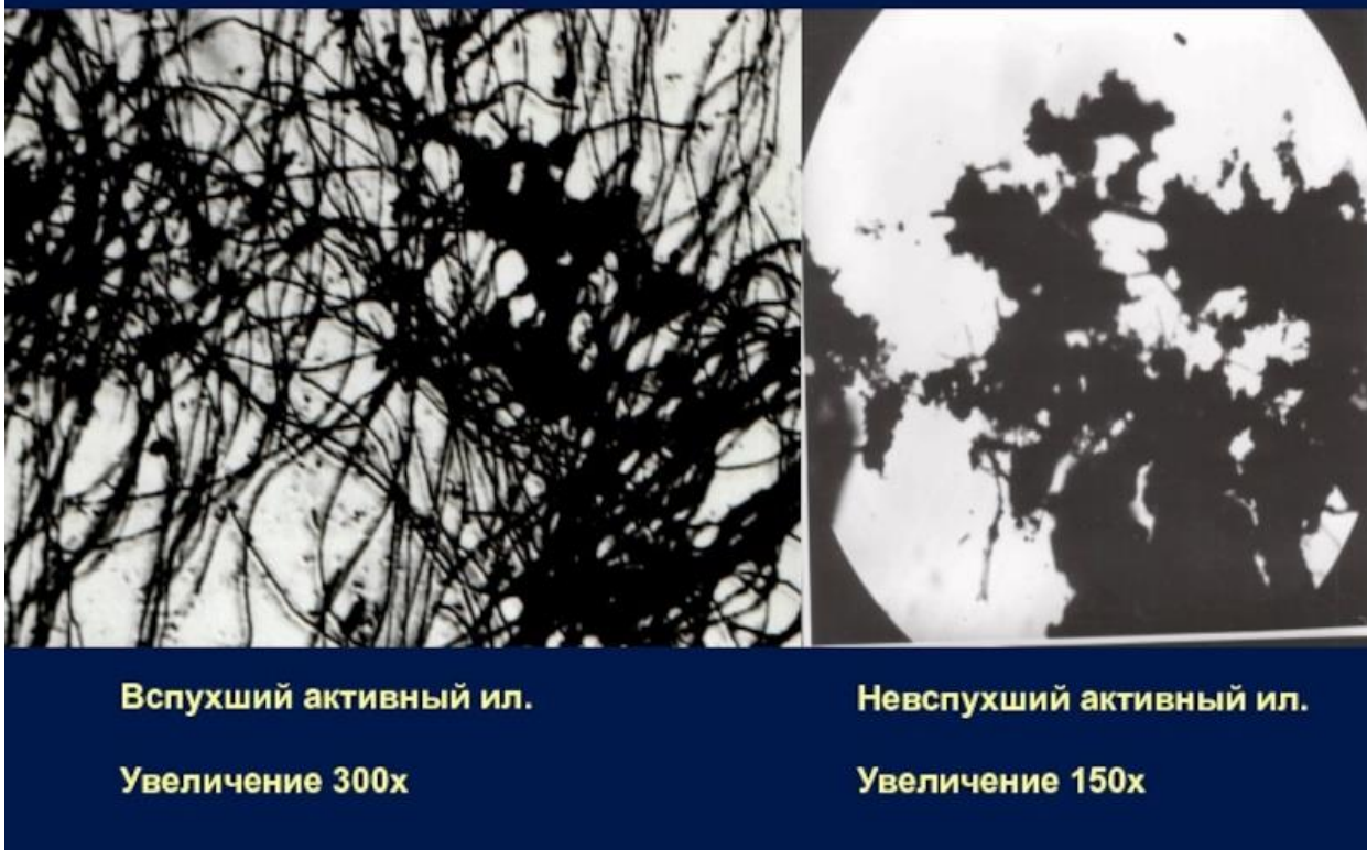
Рисунок 5 - Вспухание активного ила при рассмотрении его под микроскопом
