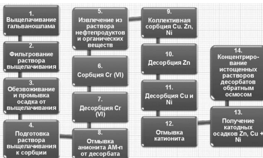
Рисунок 1 – Функциональная схема обезвреживания и утилизации гальваношамов сложного состава
