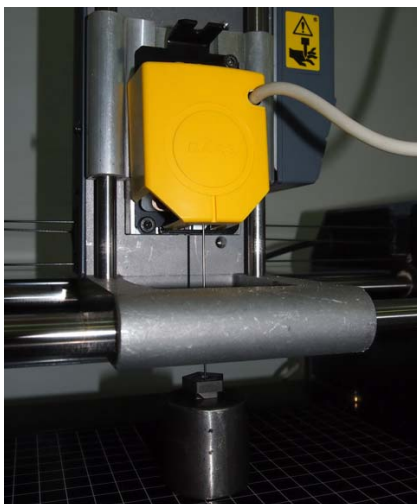
Рис. 2.3. Обход шупом поверхности пластины
